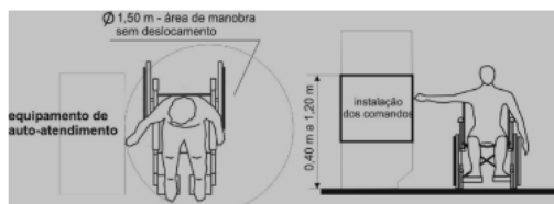
Equipamentos de Autoatendimento
